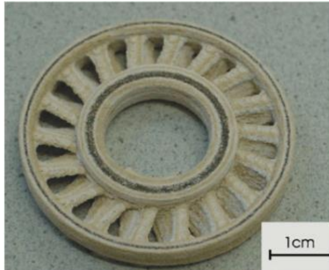
Figura 5: Roda de turbina fabricada por SL [9].
